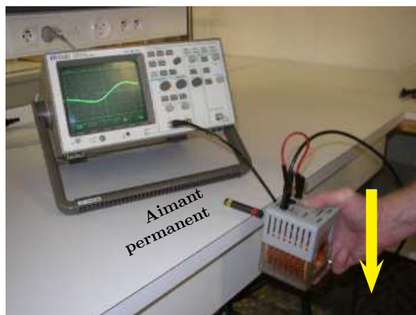
FIGURE 2 – Conducteur mobile dans un champ magnétique statique
