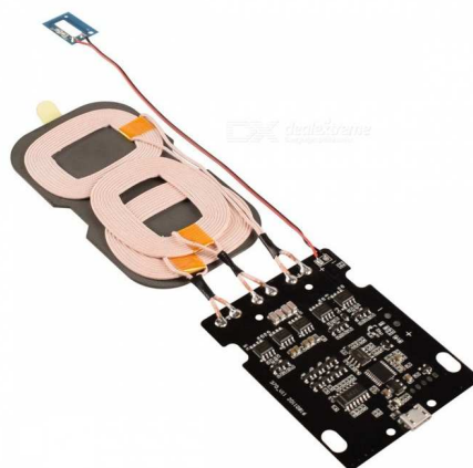
FIGURE 10 – Intérieur de la base d'un dispositif de recharge d'un téléphone portable
