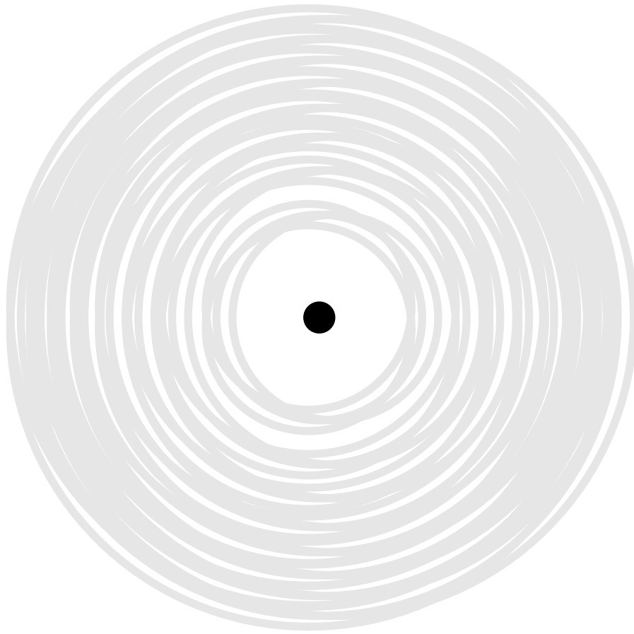
FIGURE 15 – Brouillage des franges avec une source large observées à distance finie
