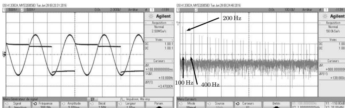
FIGURE 6 – Spectre du signal échantillonné en dessous du critère de SHANNON
