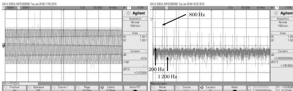
FIGURE 5 – Spectre du signal échantillonné sur une longue durée
