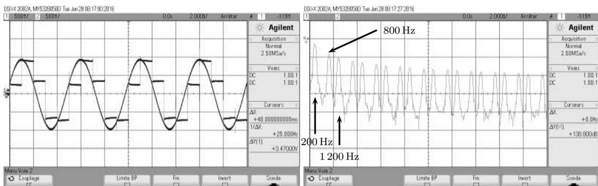
FIGURE 4 – Spectre du signal échantillonné sur une durée de 4 périodes
