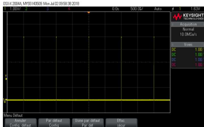
FIGURE 13 – Petite portion d'un peigne de DIRAC dans le domaine temporel
