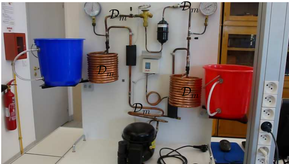
FIGURE 5 – Pompe à chaleur avec la tuyauterie visible - Débit massique \mathcal{D}_m identique dans toute la tuyauterie
