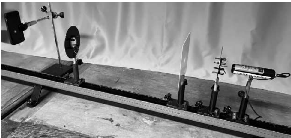
FIGURE 14 – Dernier montage : détermination de la taille d'un pixel
