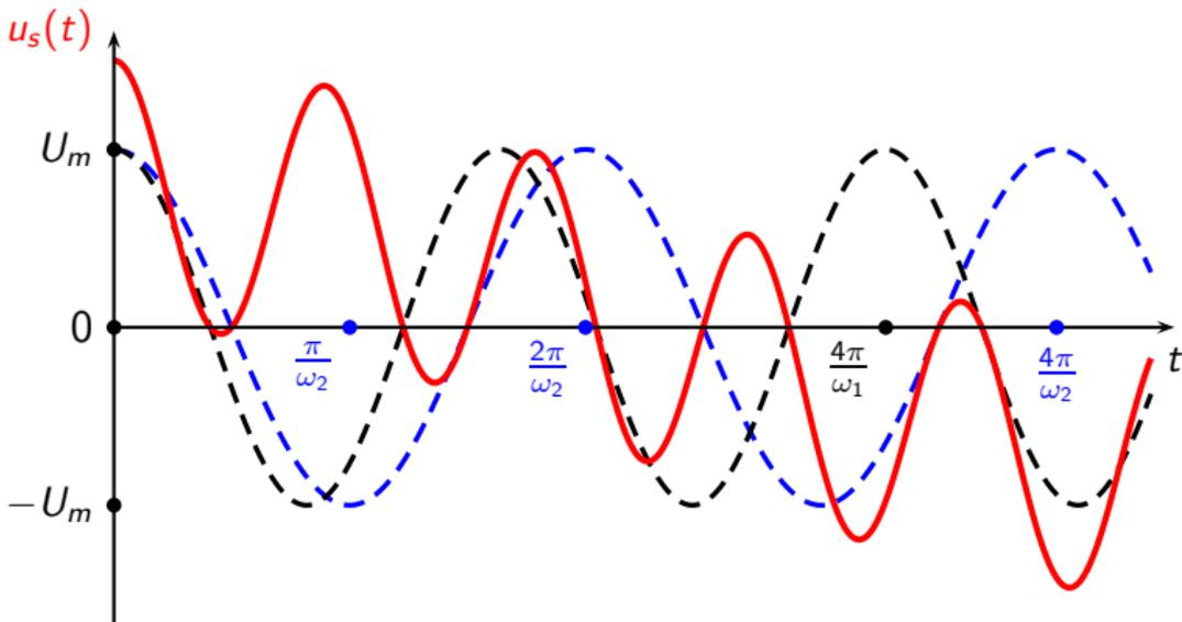
On constate sur le graphique que la tension  $u_s(t)$  issue du produit de signaux de pulsations  $\omega_1$  et  $\omega_2$  est bien la superposition d'un signal **haute fréquence** correspondant à  $\omega_1 + \omega_2$  et d'un signal **basse fréquence**  $\omega_1 - \omega_2$  :
