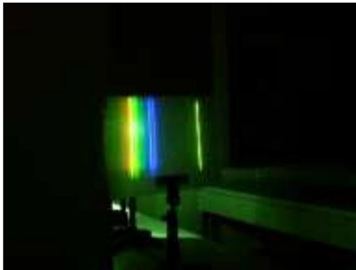
Le spectre est discontinu formé de raies fines. Les lampes les plus classiques sont celle à mercure Hg observée ici et celle à sodium Na. La raie la plus intense pour le mercure est verte de longueur d'onde  $\lambda = 541,6 \text{ nm}$  de largeur  $\Delta\lambda \leq 1 \text{ nm}$ .
