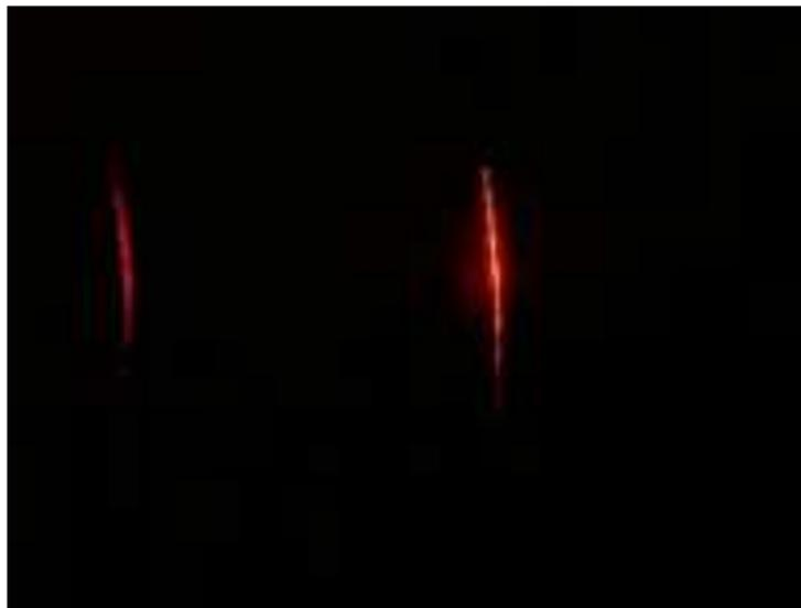
Le spectre est formé d'une seule raie très fine, on parle de source monochromatique. La laser de couleur rouge utilisé en TP est un *hélium - néon* de longueur d'onde  $\lambda = 632,8 \text{ nm}$  et de largeur  $\Delta\lambda \simeq 10^{-3} \text{ nm}$ .
