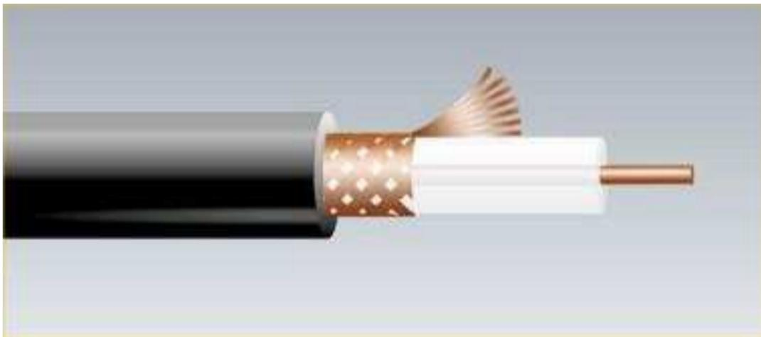
Le signal est transporté par le fil de cuivre central (âme). Ce dernier est entouré d'un isolant plastique. Autour de l'isolant, on trouve un conducteur qui assure la fermeture du circuit. Ce conducteur est souvent relié à la masse des appareils auxquels le câble coaxial est branché. Nous verrons plus tard que ce conducteur périphérique protège, par phénomène de blindage, le signal des perturbations électromagnétiques. Enfin, le câble est entouré d'une gaine de protection plastique.
