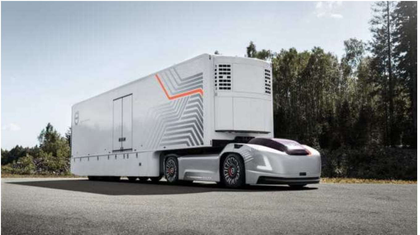
FIGURE 17 – Prototype de camion électrique autonome sans cabine Volvo
