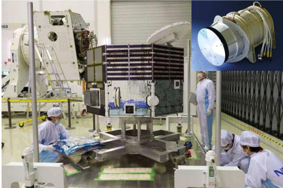
FIGURE 3 – La sonde MMO de BepiColombo en cours d'intégration. En insert, photo de l'analyseur de particules MSA fabriqué au LPP.
