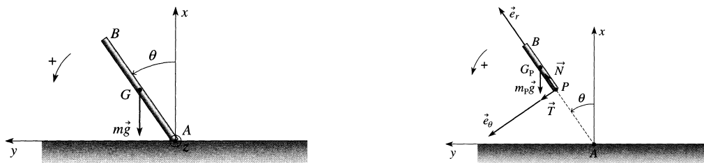
FIGURE 2 – Bilan des forces sur la tige et sur une portion de celle-ci
