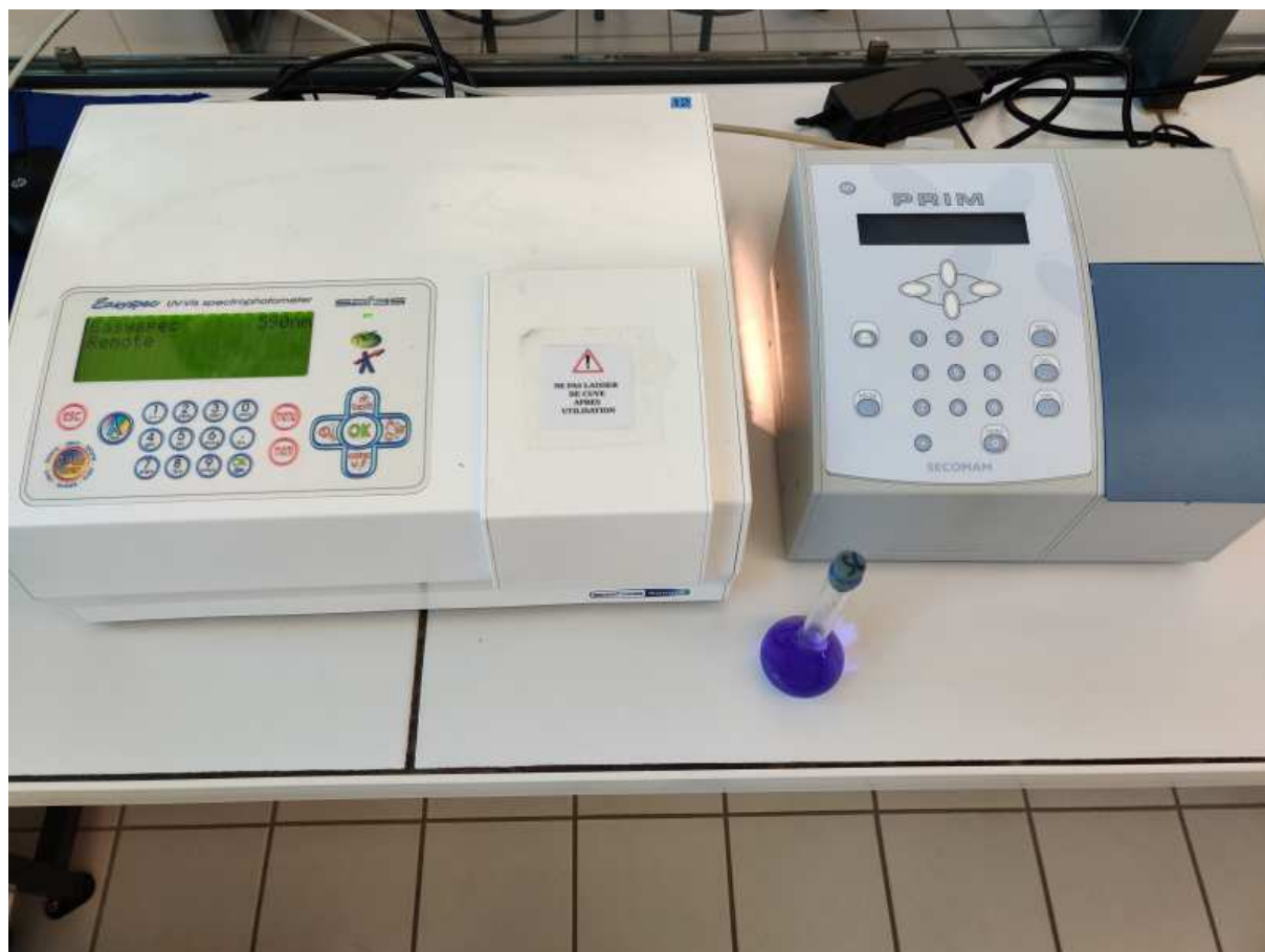
FIGURE 1 – La solution de BBP et les spectrophotomètres Safas et Secomam Prim
