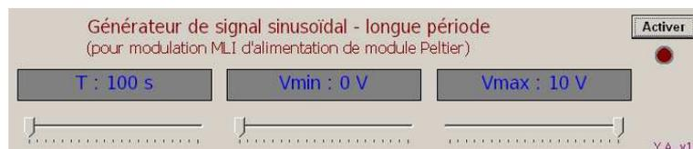
FIGURE 6 – Interface de pilotage du rapport cyclique
