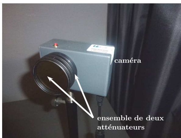
FIGURE 3 – Caméra Caliens permettant de mesurer l'éclairement
