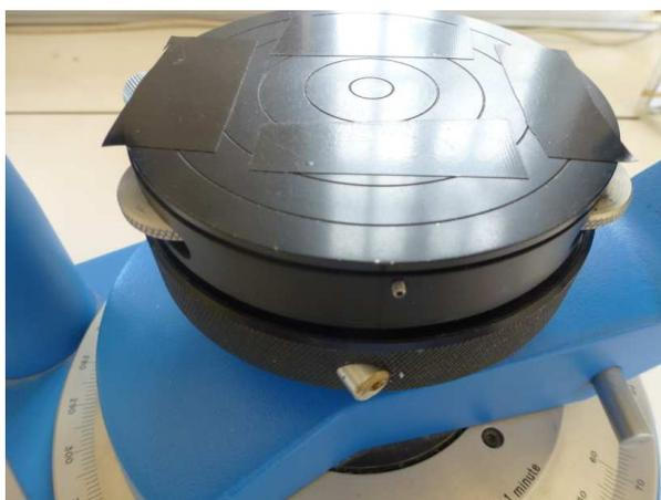
FIGURE 6 – Plateau et vis de réglage
