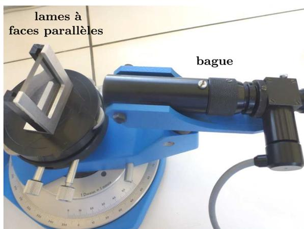
FIGURE 3 – Réglage de la lunette autocollimatrice
