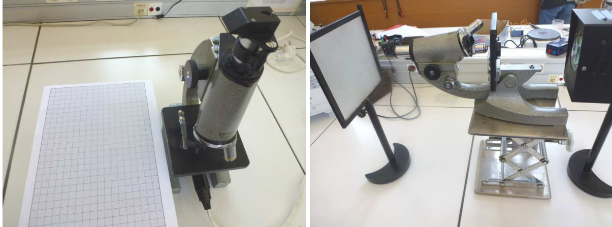
FIGURE 4 – Microscope et chambre claire - Microscope placé horizontalement
