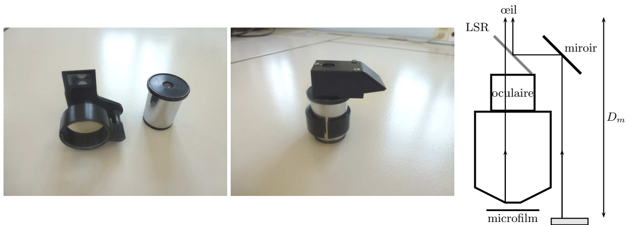
FIGURE 3 – La chambre claire montée sur un oculaire et son principe
