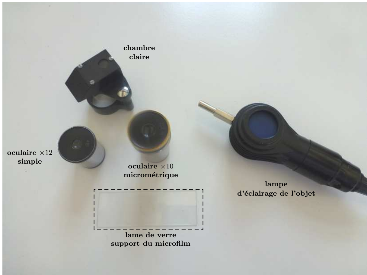
FIGURE 2 – Éléments amovibles du microscope
